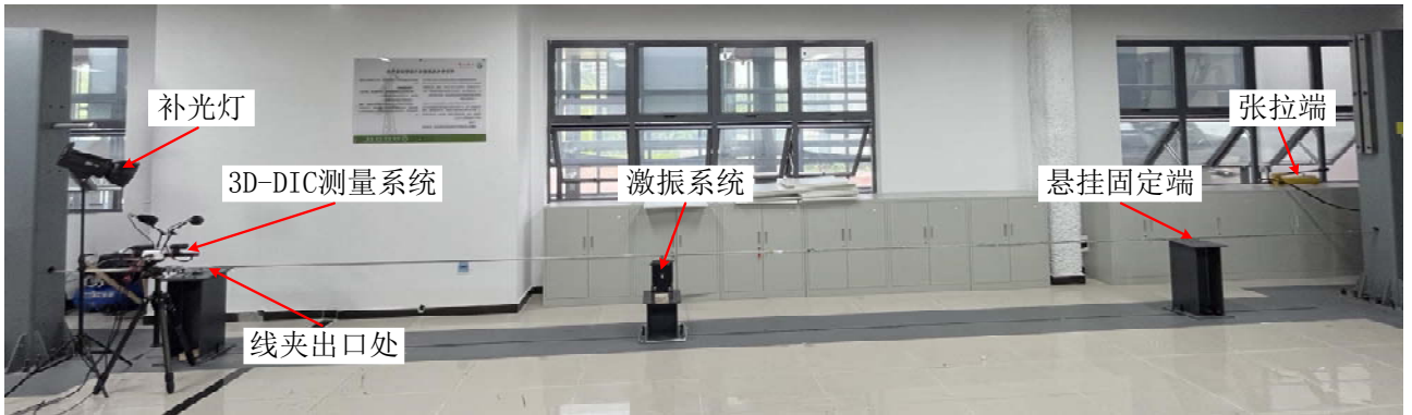
图5 导线微风振动动弯应变测量现场
